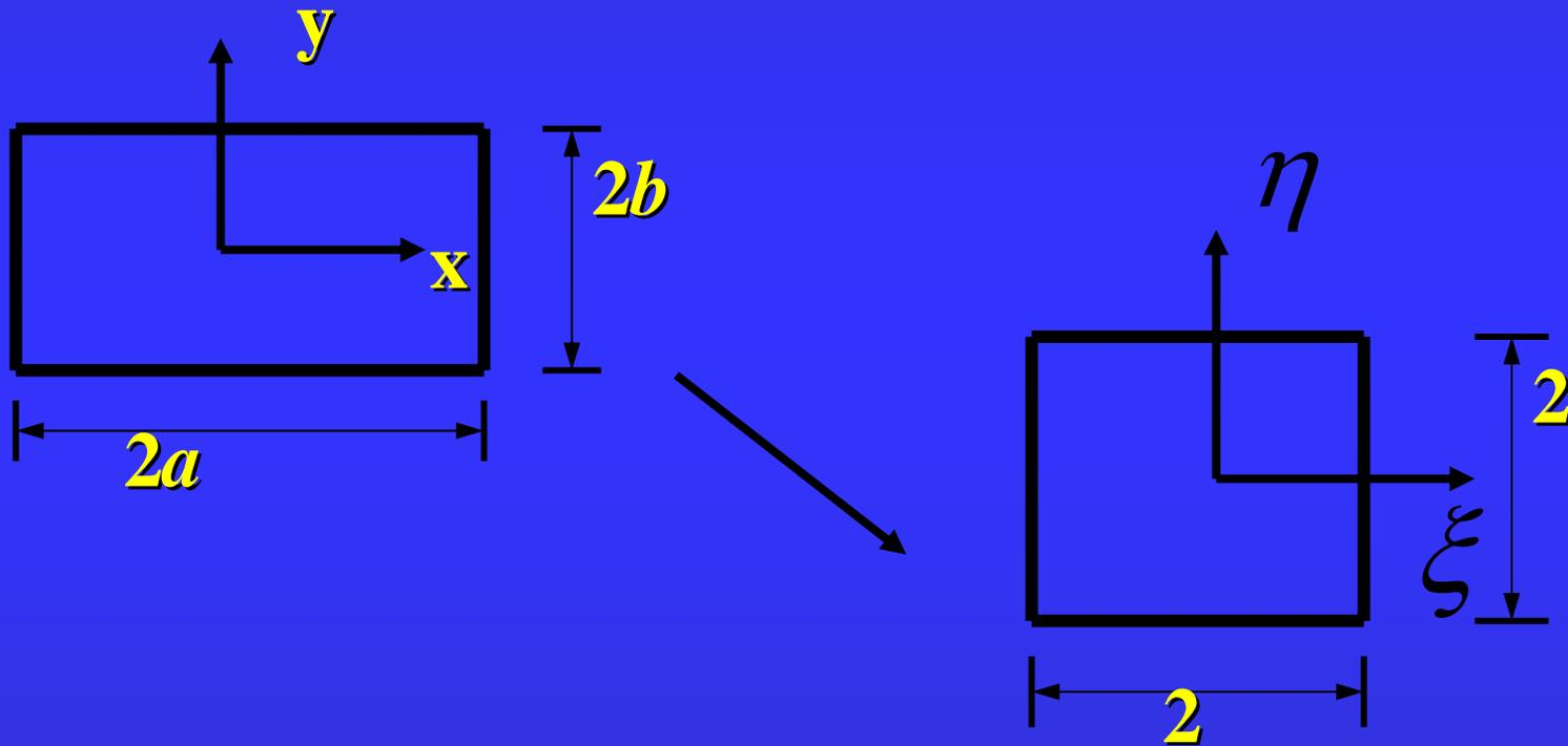
图示矩形单元，设  $\xi=x/a$ ， $\eta=y/b$ ，则转换成正则单元。
