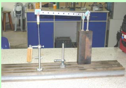
自制的冲击试验台
